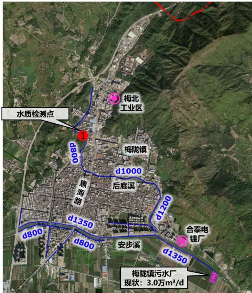
图 3.3-1 污水系统主干管+污水厂服务范围
