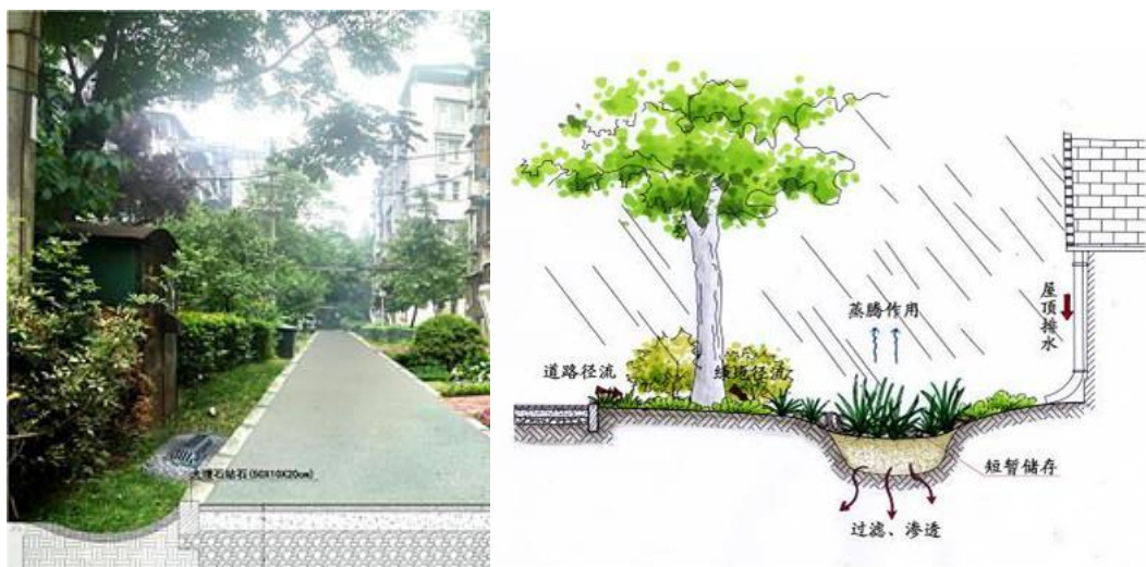
图 5-20 下沉式绿地典型构造示意图
